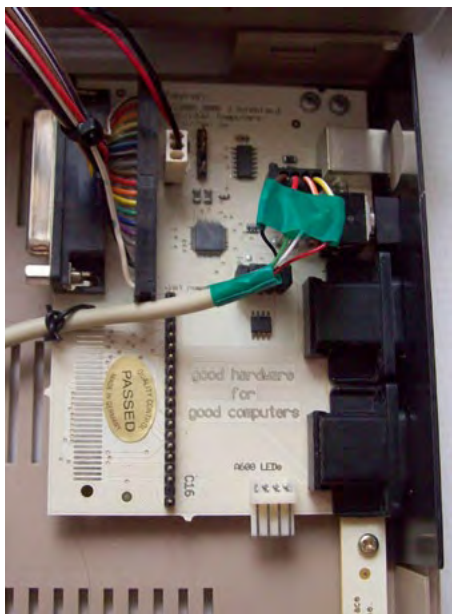
Das Keyrah mit dem USB-Kabel über den Pins
