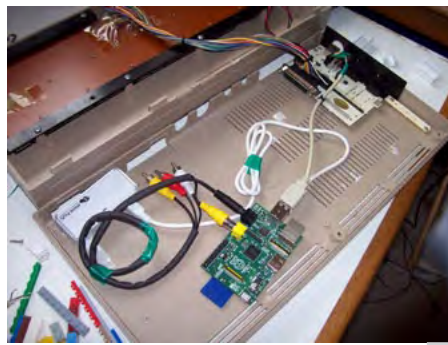
Keyrah und Pi am USB-Hub angeschlossen
